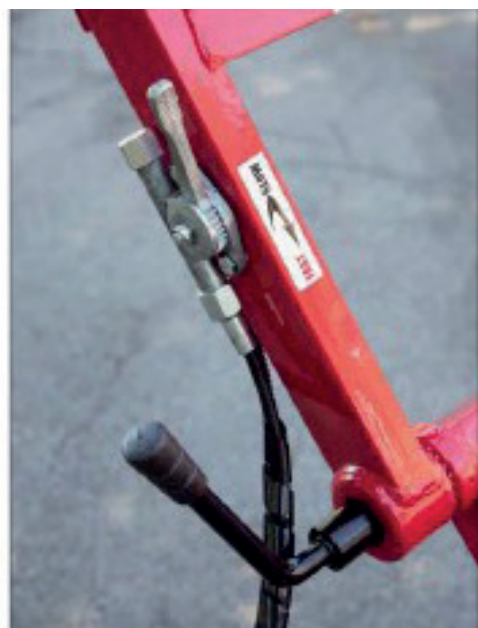
Der Gashebel für die Motordrehzahl befindet sich auf der rechten Seite des Führungsholms
