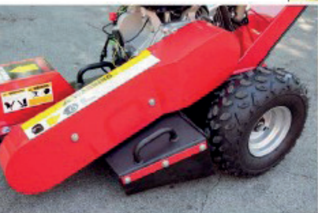
Auf der linken Geräteseite befindet sich der Auswurfschacht für das Häckselgut
