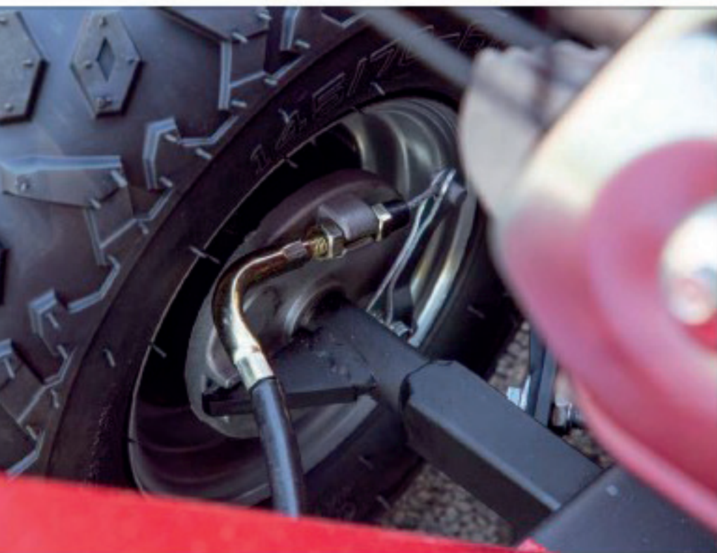
Das linke Rad ist mit einer Feststellbremse versehen und wird so zum Drehpunkt der Maschine beim Fräsen
